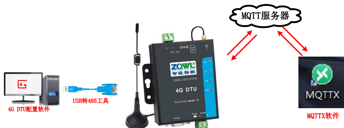
图 12.1 MQTTX 与 4G RTU 设备通信拓扑
