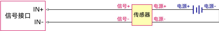
电压信号采集差分接线图
