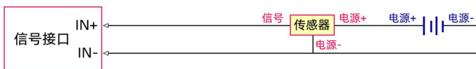
三线制电流信号采集差分接线图
