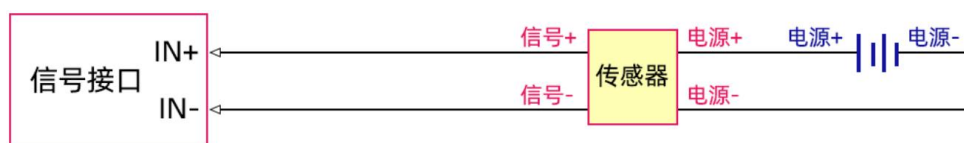
四线制电流信号采集差分接线图
