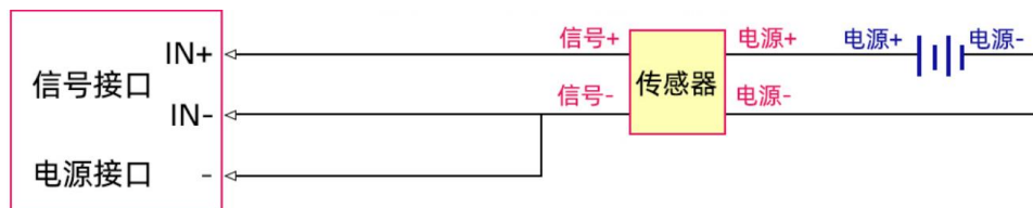
四线制电流信号采集单端接线图
