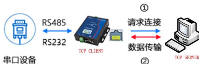
图 4.8 TCP CLIENT 模式工作原理
