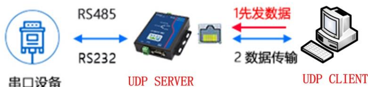
图 4.13 UDP SERVER 模式工作原理
