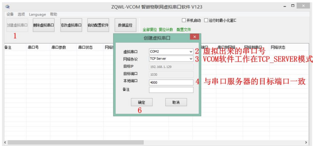
图 4.27 设备在 TCP_CLIENT 模式下创建虚拟串口
