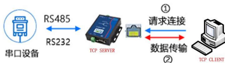
图 4.2 TCP SERVER 模式工作原理
