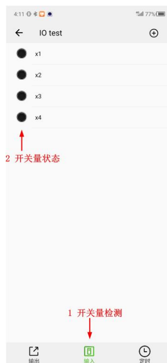
图 15 远程检测开关量输入状态
