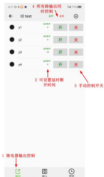
图 14 远程控制继电器输出
