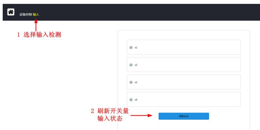
图 10 设备开关量输入检测界面
