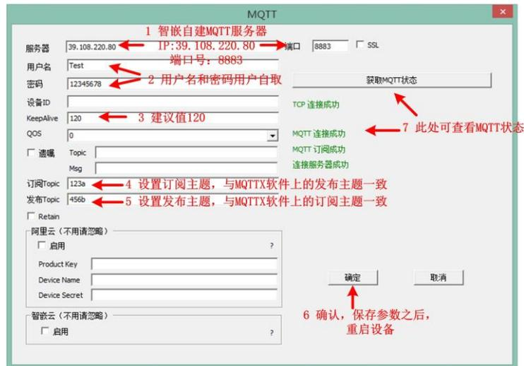
图 4.6 MQTT 配置
