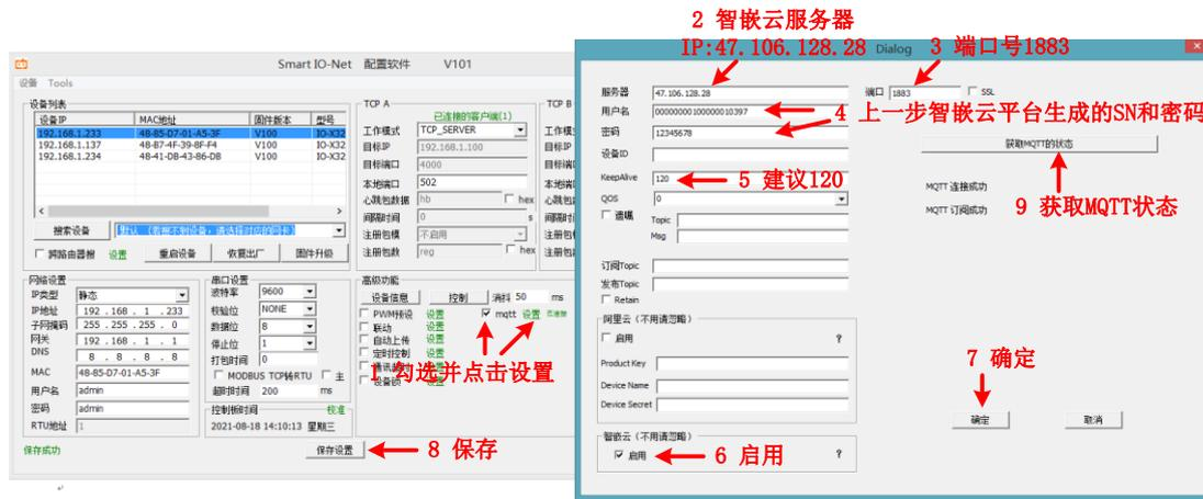
图 8.7 设备参数配置
