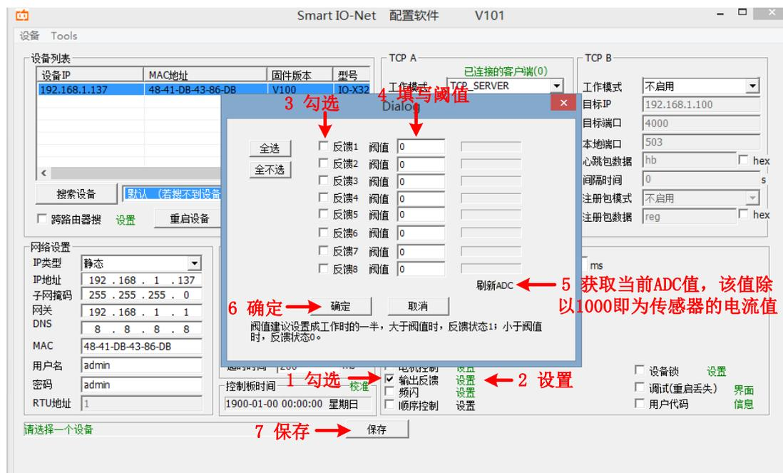
图 2.22 输出反馈配置
