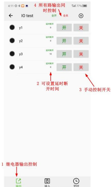
图 8.14 远程控制继电器输出
