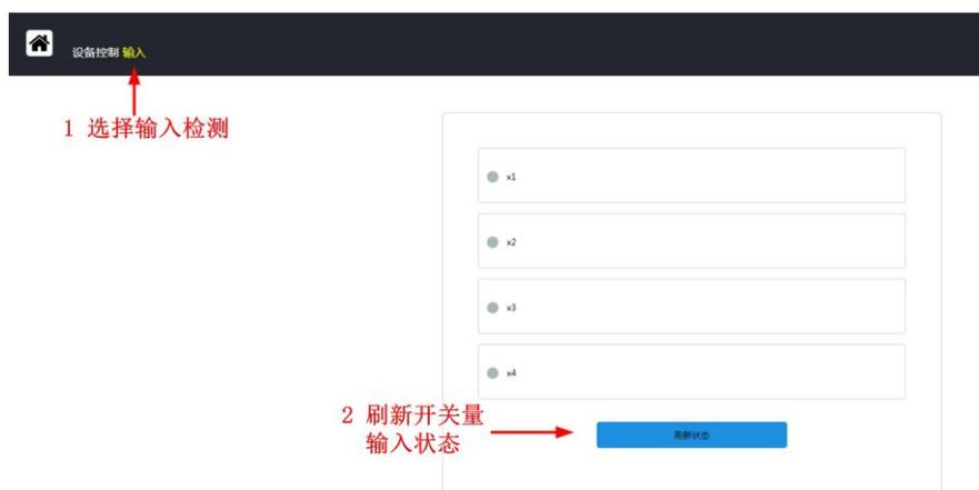
图 8.10 设备开关量输入检测界面
