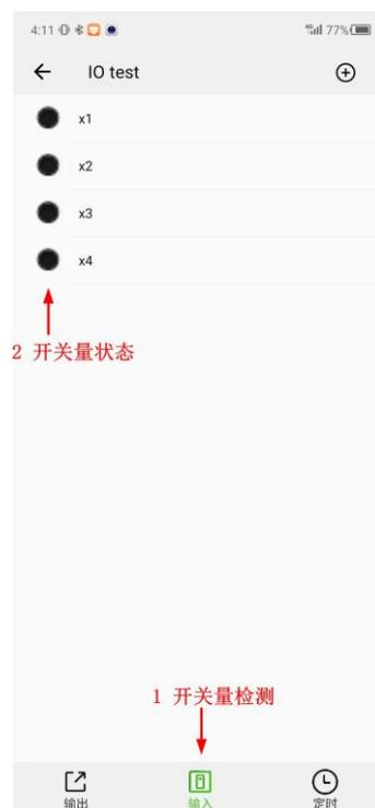
图 8.15 远程检测开关量输入状态
