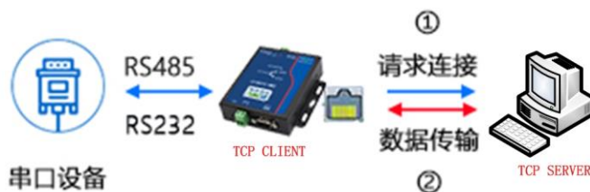
图 3.5 TCP CLIENT 模式工作原理
