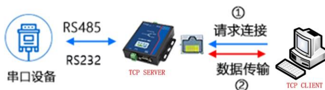
图 3.2 TCP SERVER 模式工作原理
