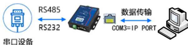
图 3.20 虚拟串口工作原理
